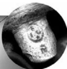
Рис. 6. Клеймо бельгійської контрольної служби з випробування зброї стрільбою (м. Льеж).
